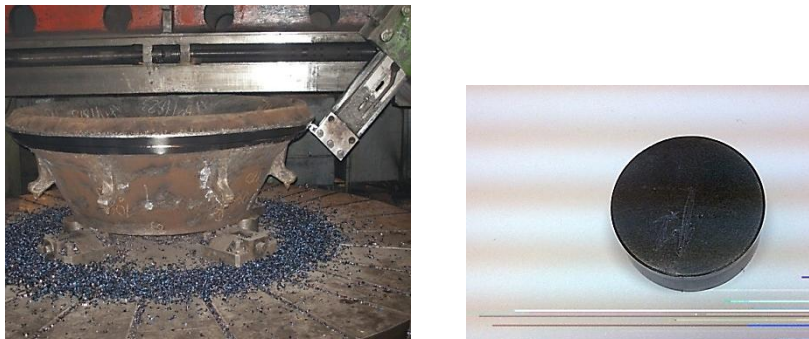
Рис. 1. Обробка броні (сталь 110Г13Л) конічної дробарки на токарно-карусельних верстатах за допомогою різців, оснащених пластинами КНБ
